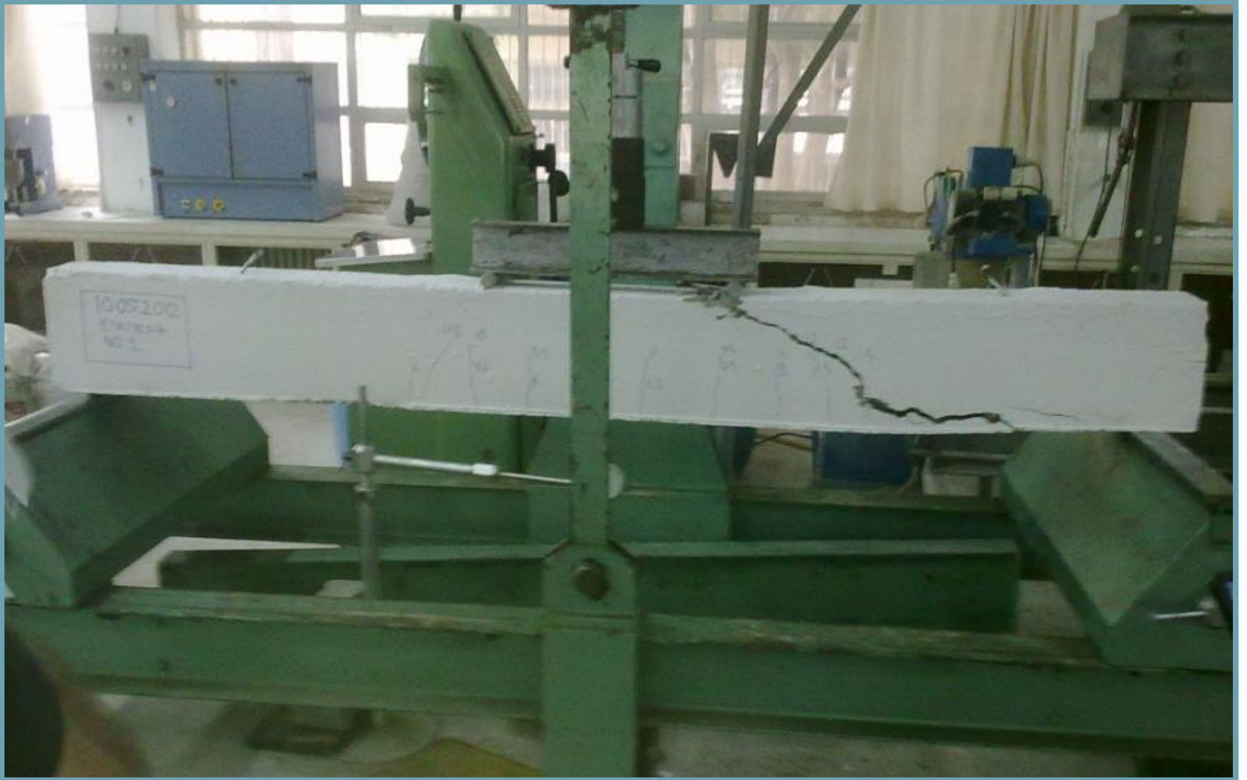
2. Kiriş Eğilme Deneyi: Kesit geometrisi, beton sınıfı ve eğilme donatısı aynı tek farkı etriyesiz olması- 10/5/2012
