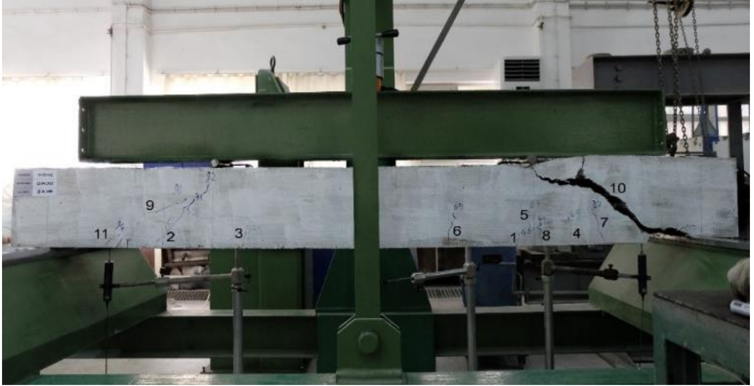
KI-DD-3-2 Numunesinde Oluşan Çatlaklar
